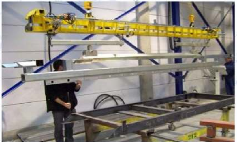
Poste de chargement pour une ligne de cathorèse
