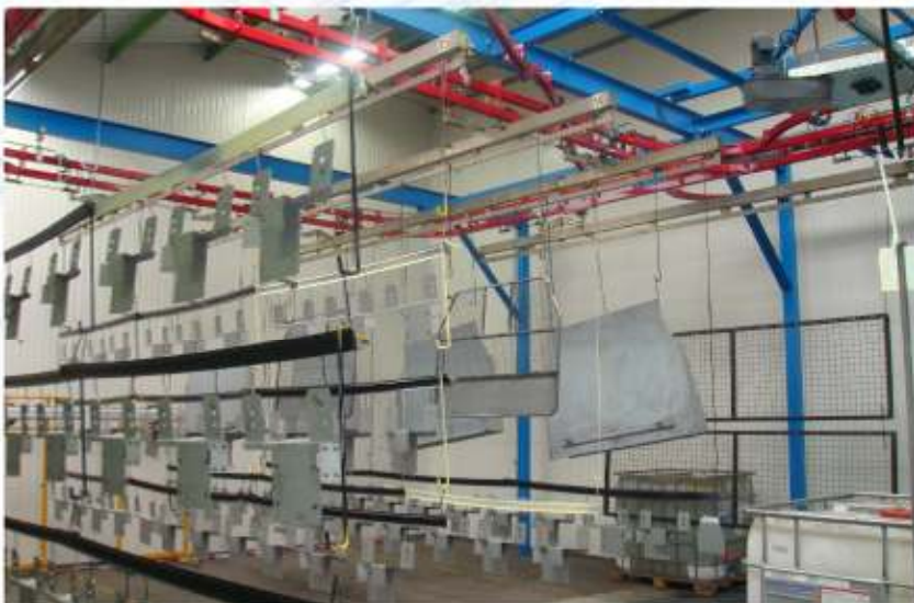
Transferts de palonniers sur des voies parallèles motorisées
