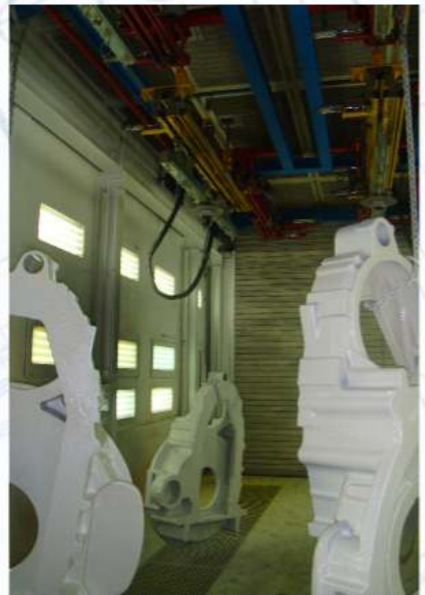
Elévateurs intégrés à la cabine de peinture
