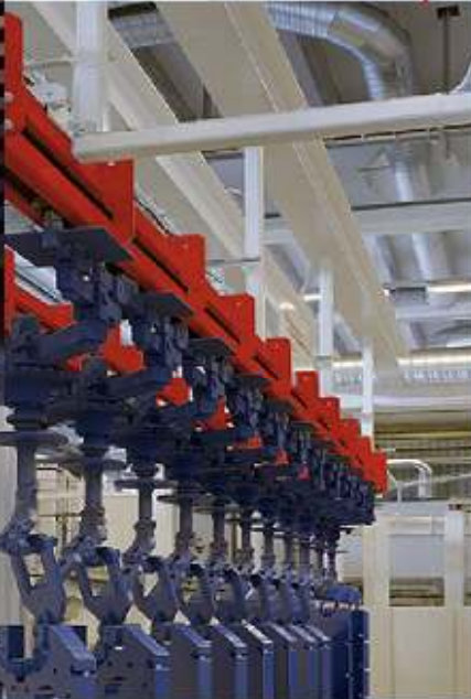
Palonniers avec dispositifs de rotation
